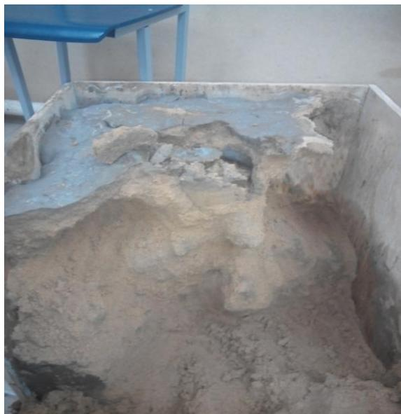
Рисунок 5 – Полученная область инъектирования
