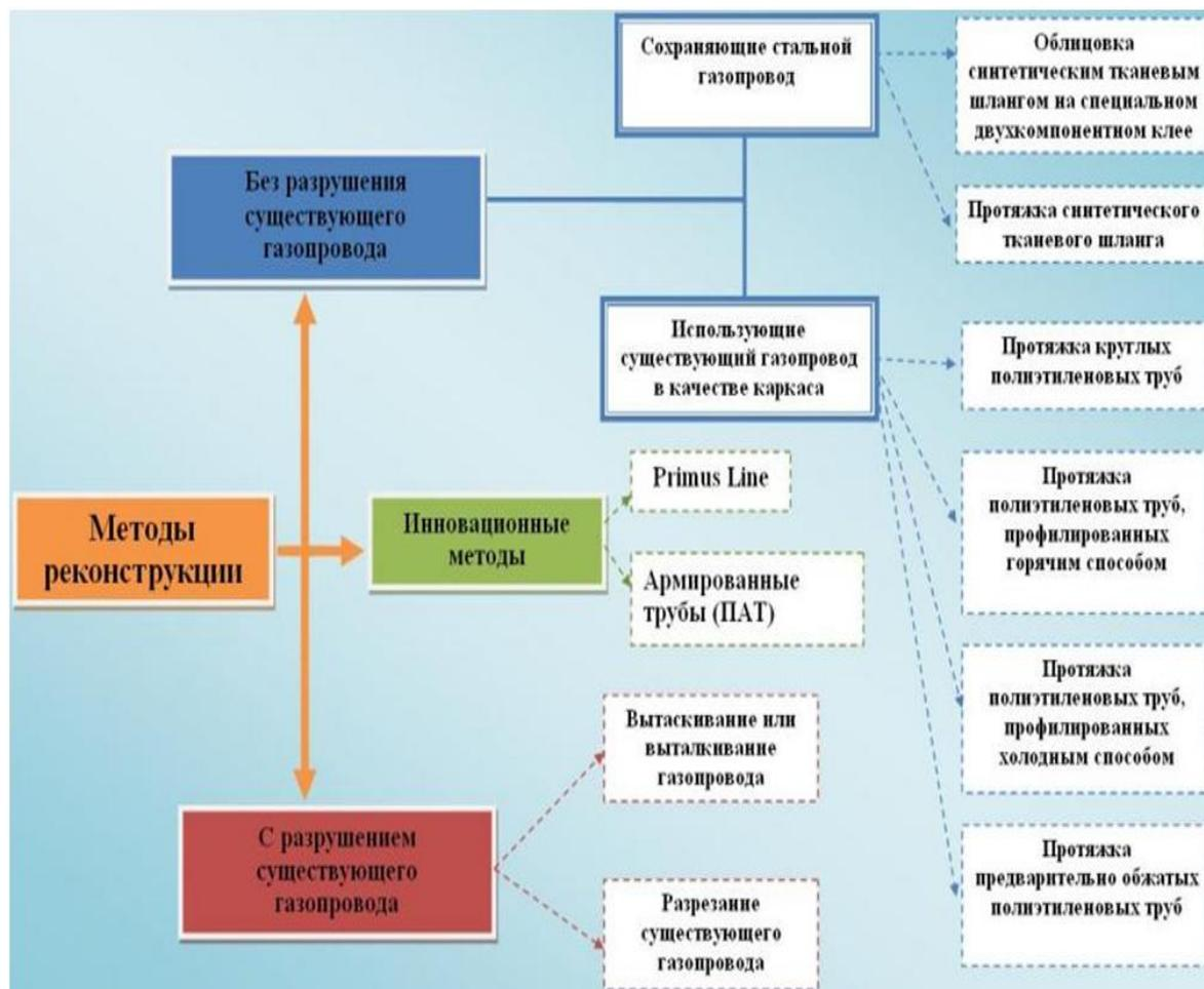
Рисунок 1 – Методы реконструкции изношенных газопроводов
