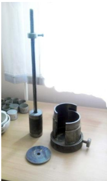
Рисунок 1 – Прибор стандартного уплотнения грунта
