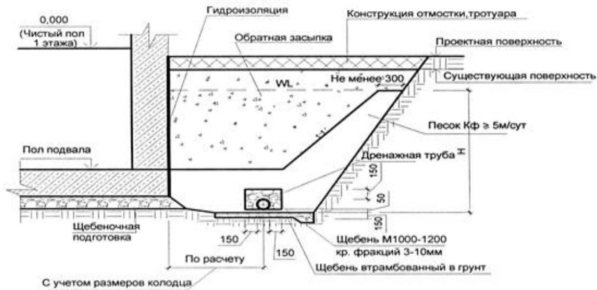
Рисунок 1 – Дренаж совершенного типа
