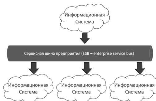
Рисунок 1 – Схема применения сервисной шины
