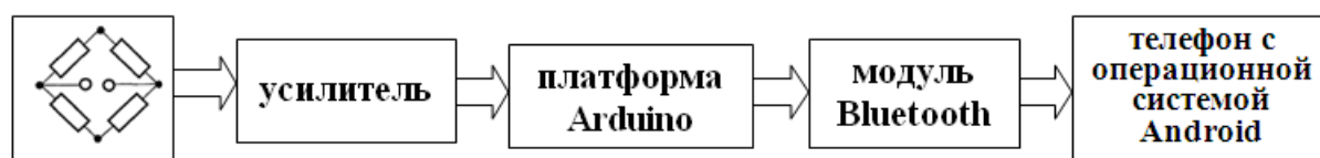
Рисунок 1 – Структурная схема информационно-измерительной системы
