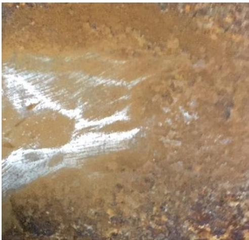
Рисунок 2 – Фрагмент №1 изображения трубы с толщиной коррозии менее 0,005 мм
