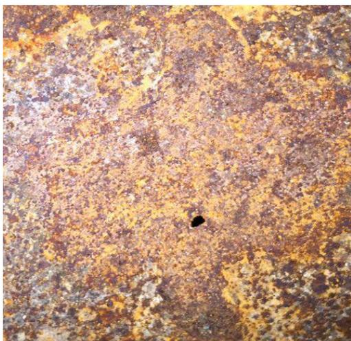
Рисунок 6 – Фрагмент №3 изображения трубы с толщиной коррозии 0,03 мм
