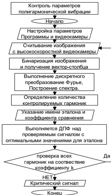
Рисунок 2 – Алгоритм разрабатываемого программного обеспечения, блок «Контроль параметров полигармонической вибрации»
