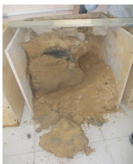
Рисунок 8 - Полученная область инъектирования (В/Ц-1:7; давление 4 атм.)
