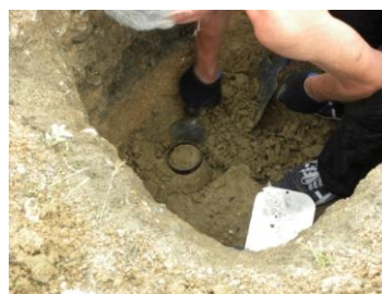
Рисунок 3 – Отбор проб грунта методом режущего кольца
