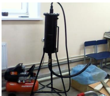
Рисунок 5 – Лабораторная установка для инъектирования грунтов в лабораторных условиях
