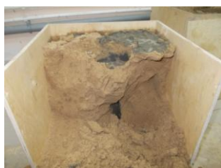
Рисунок 7 – Полученная область инъектирования (В/Ц-1:5; давление 2 атм.)
