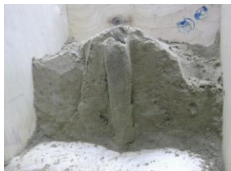
Рисунок 6 – Полученная область инъектирования (В/Ц – 1:3; давление 6 атм.)
