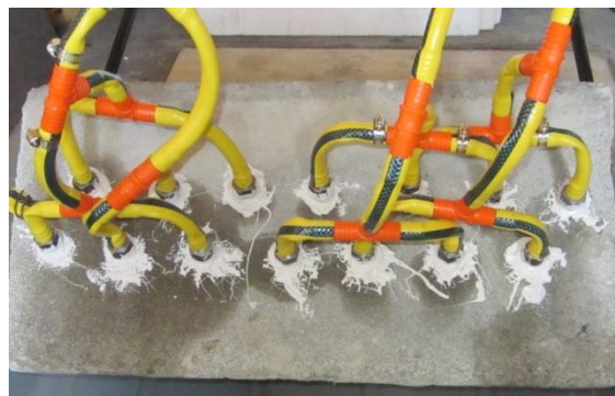
Рисунок 6 – Подача гидрофобизирующего состава в пенобетон
