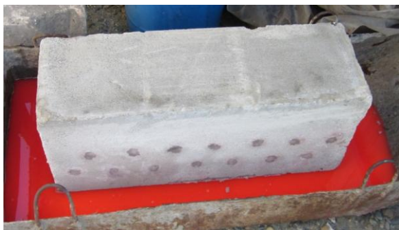
Рисунок 7 – Замачивание образца обработанного гидрофобизирующим составом
