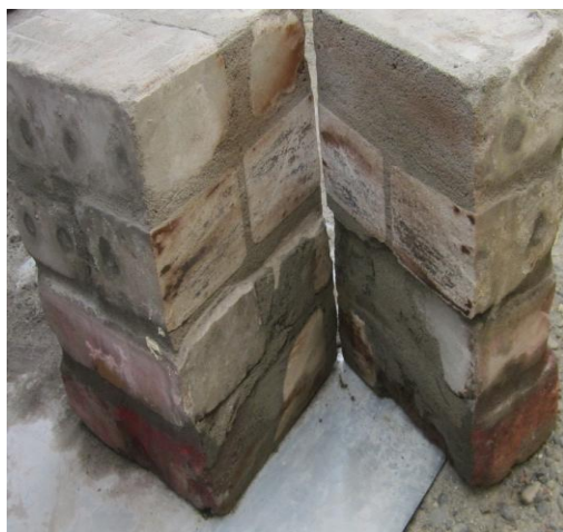
Рисунок 5 – Вскрытие образца после инъекционной гидрофобизации
