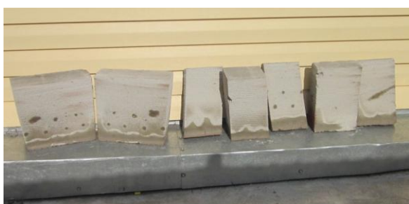
Рисунок 8 – Вскрытие образца после замачивания
