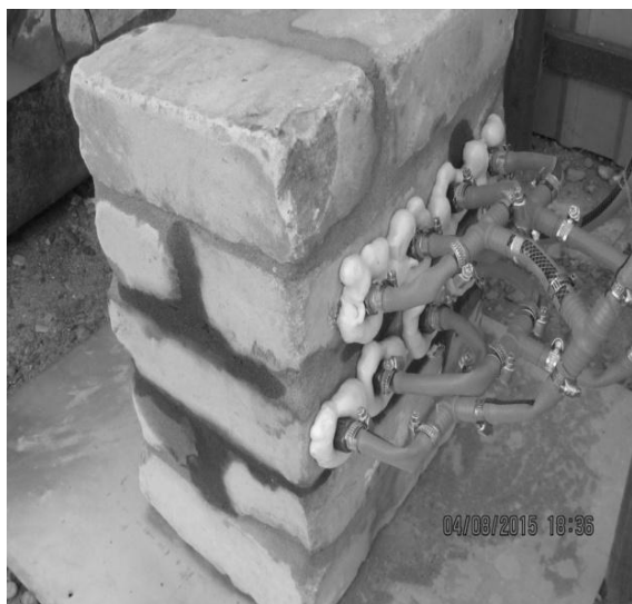
Рисунок 3 – Испытания по устройству объемной гидрофобизации
