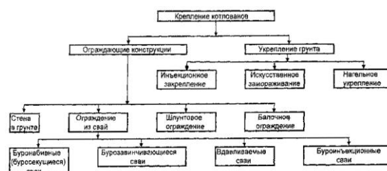
Рисунок 1 – Классификация крепления котлованов
