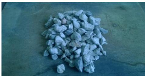
Рисунок 1 – Крупный заполнитель из отсева бетонного лома
