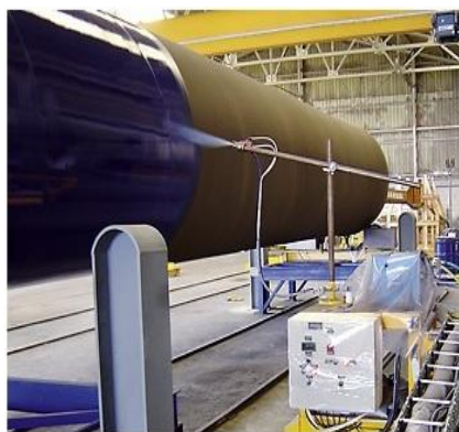
Рисунок 8 – Нанесение противокоррозионного полимочевинуретанового покрытия «Форпол»
