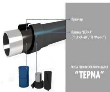
Рисунок 6 – Гидроизоляционное покрытие термоусаживающейся лентой «ТЕРМА»
