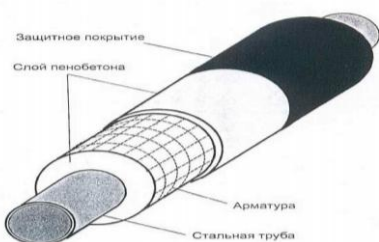
Рисунок 3 – Конструкция тепловой изоляции из армопенобетона (АПБ изоляция)
