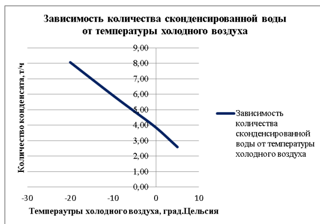
Рисунок 5 – Количество сконденсированной воды от температуры наружного воздуха
