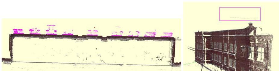
Рисунок 1 – Процесс удаления шумов со скана
