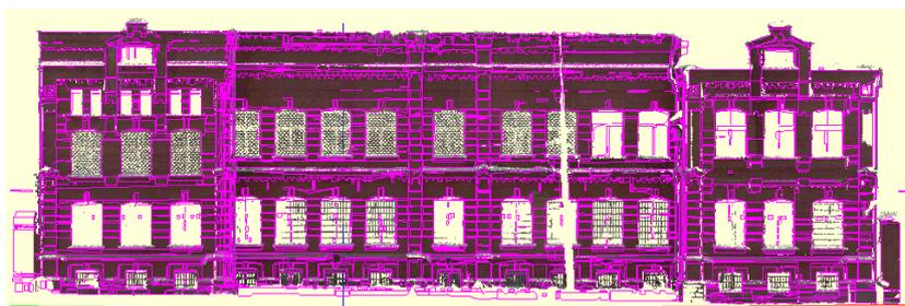
Рисунок 3 – Построение «Набора ребер» в программе ScanMaster
