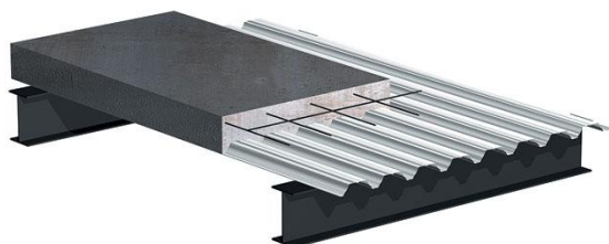
Рисунок 1 – Конструкция монолитного перекрытия из тяжелого бетона по профлисту
