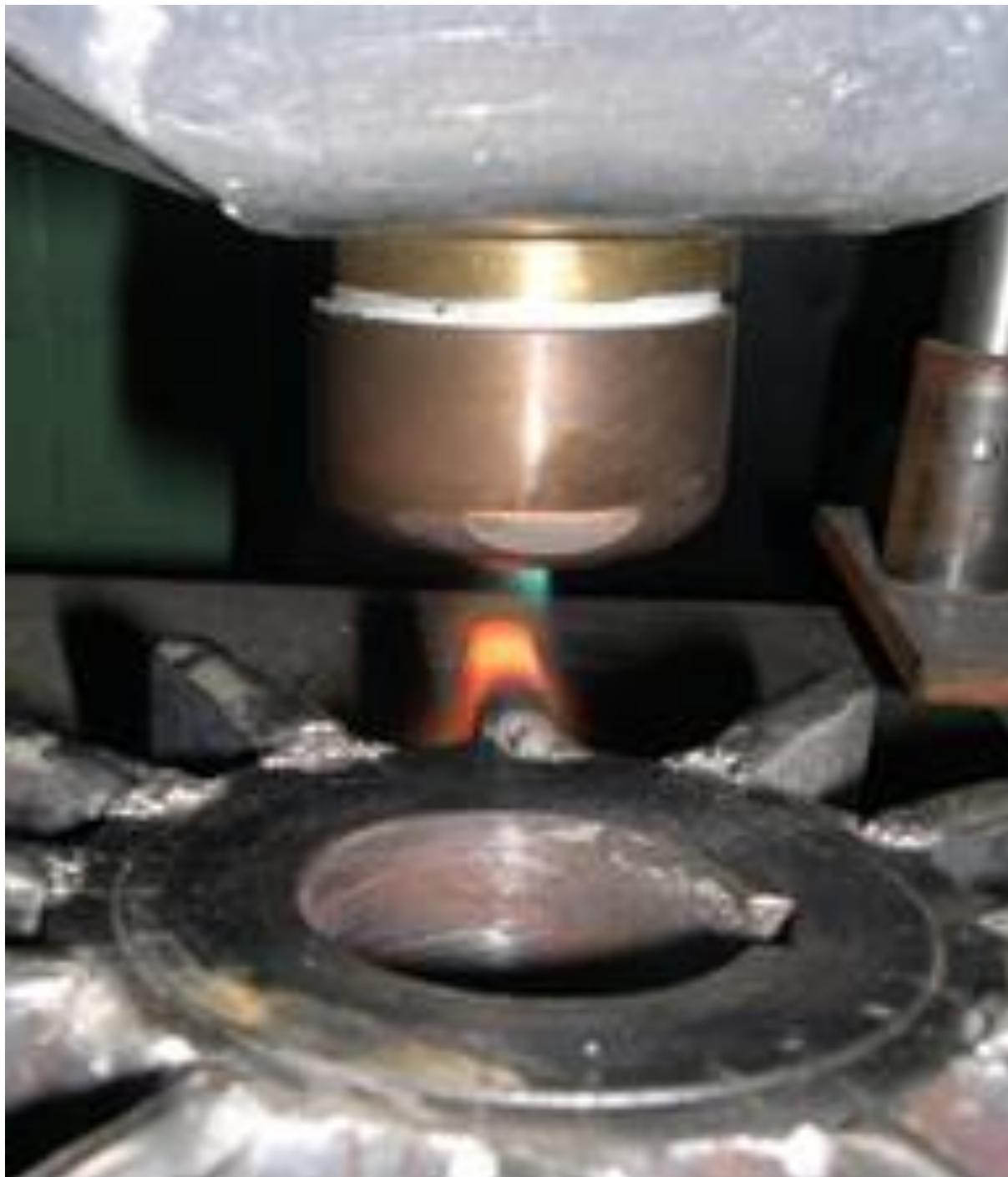
Рисунок 3 – СГП-наплавка зубьев шестерни насоса
