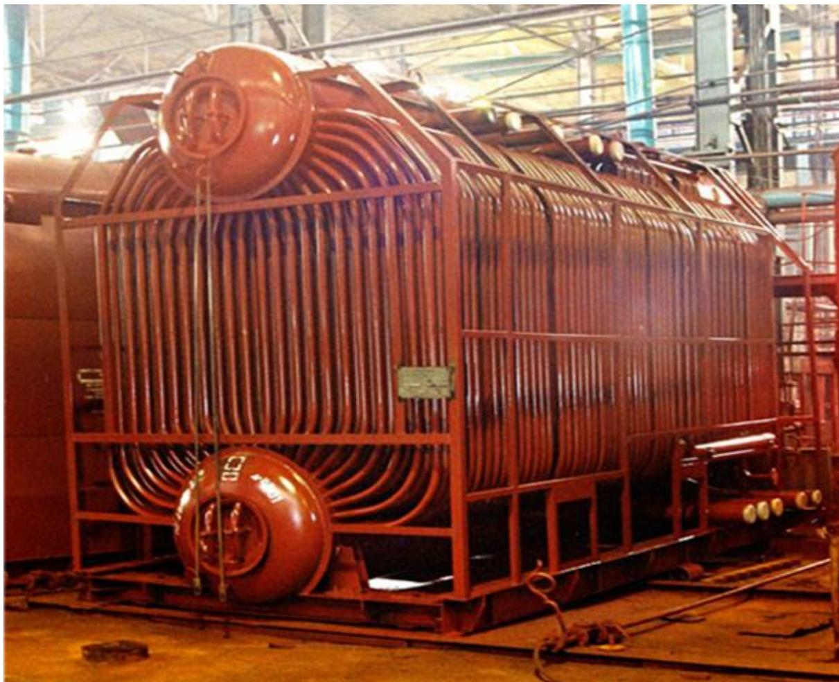
Рисунок 1 - Котёл с "кипящим слоем" разработки ОАО "Бийский котельный завод"
