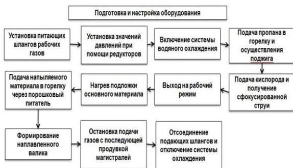
Рисунок 3 – Алгоритм подготовки и настройки оборудования
