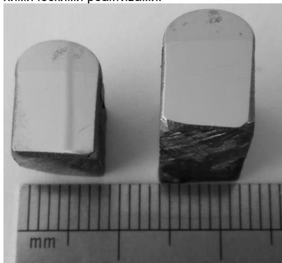
Рисунок 4 – Образцы с наплавленным металлом для проведения микроструктурного анализа
