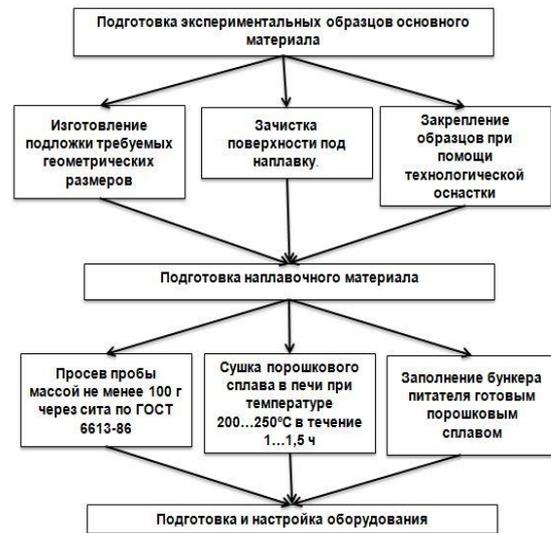
Рисунок 2 – Алгоритм нанесения защитных покрытий
