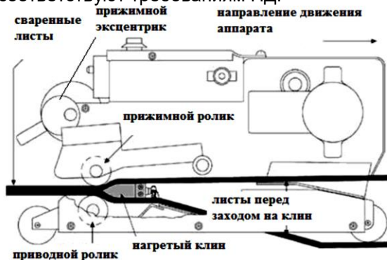
Рисунок 2 – Схема сварки нагретым клином
