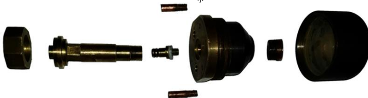
Рисунок 4 – Горелка (сопло M5) в разобранном виде
