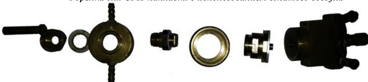
Горелка для СГП-наплавки с использованием сжатого воздуха
