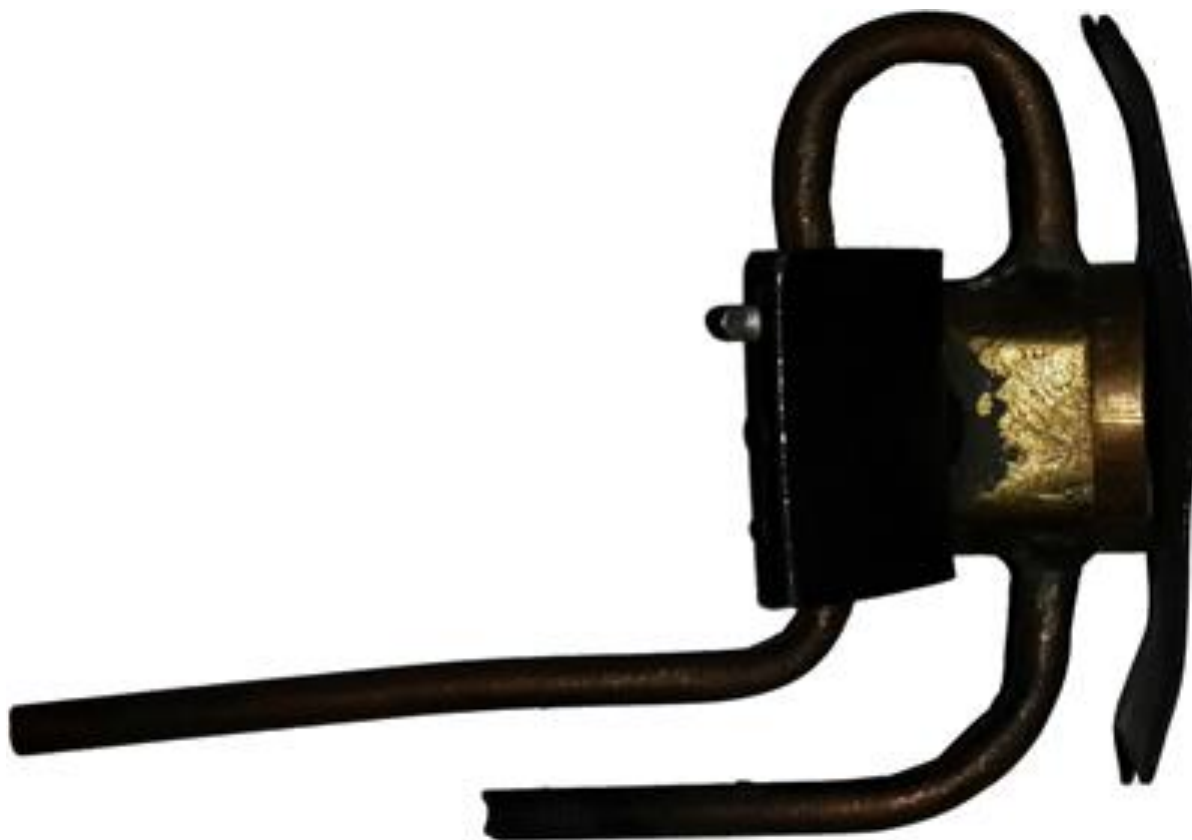
Рисунок 3 – Сопло М5 установки для СГП-наплавки
