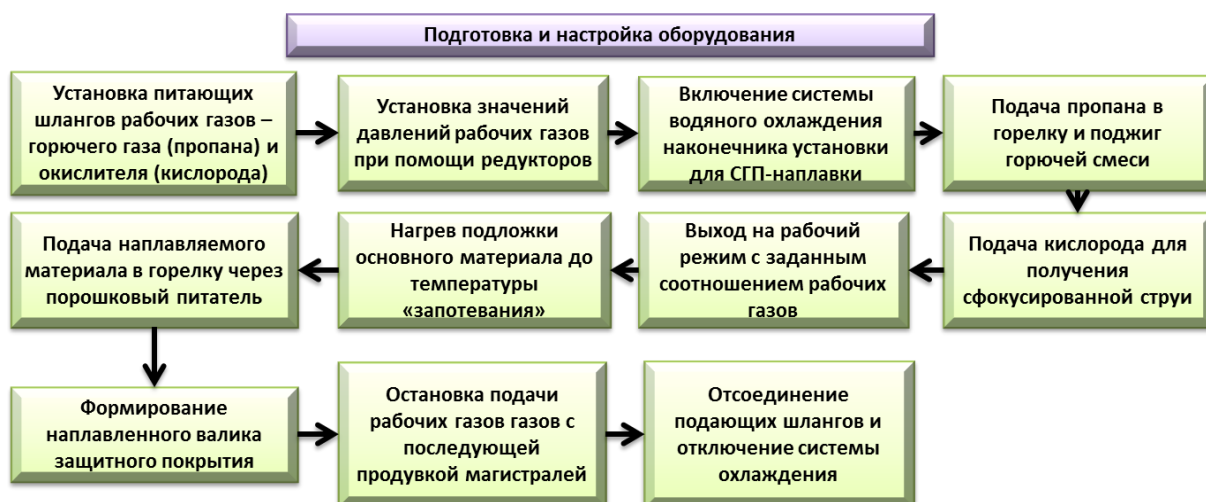
Рисунок 6 – Алгоритм подготовки и настройки оборудования
