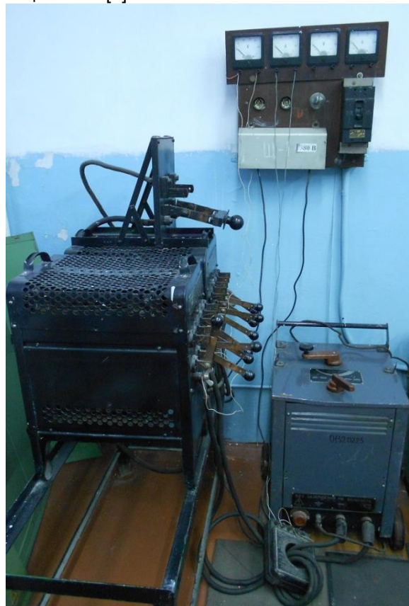
Рисунок 4 – Испытательный нагрузочный стенд с приборами для снятия внешней характеристики источников питания
