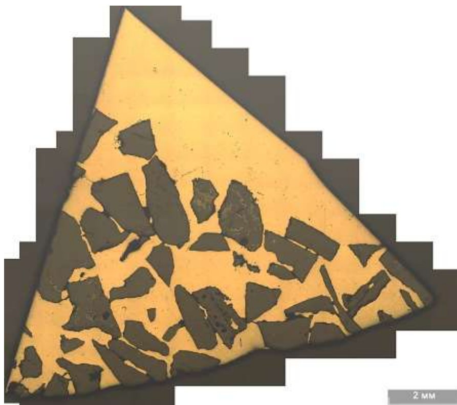
Рисунок 1 – Общая микроструктура износостойкого композита на основе ИЧХ28
