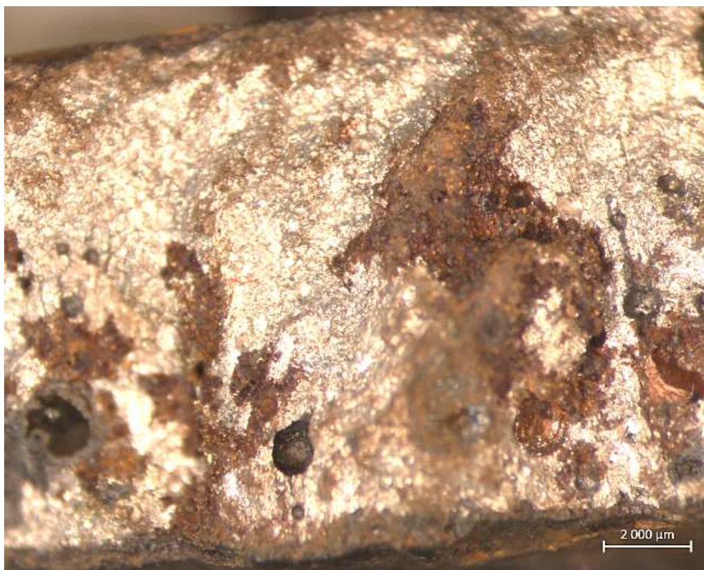
Рисунок 3 – Пористость в образце № 42 (макроснимок)
