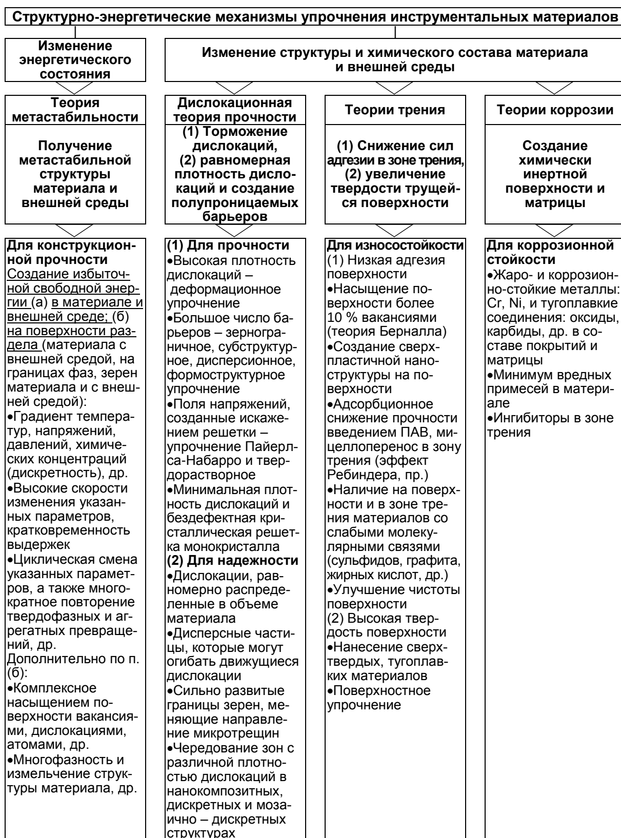
Рисунок 4 – Классификация структурно-энергетических механизмов упрочнения инструментальных материалов
