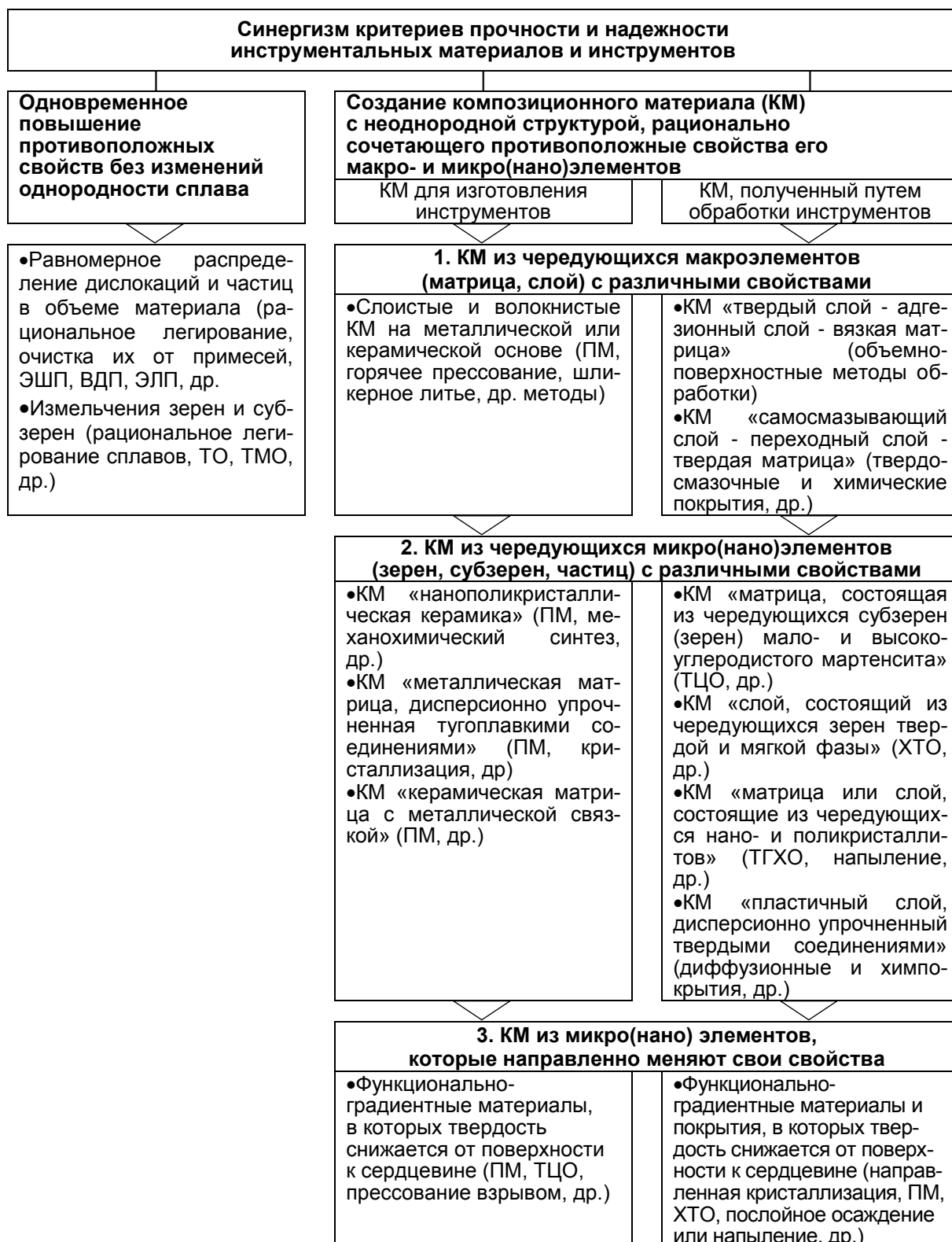
Рисунок 3 – Синергизм критериев конструкционной прочности инструментальных материалов и инструментов
