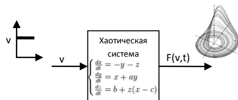
Рисунок 1 – Измерительный преобразователь на основе генератора хаоса
