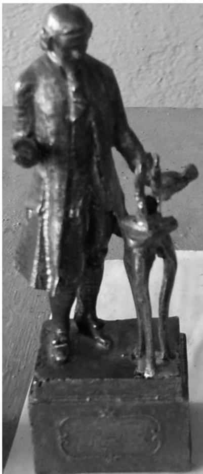
Рисунок 5 – Отливка после гальванопластики и травления
