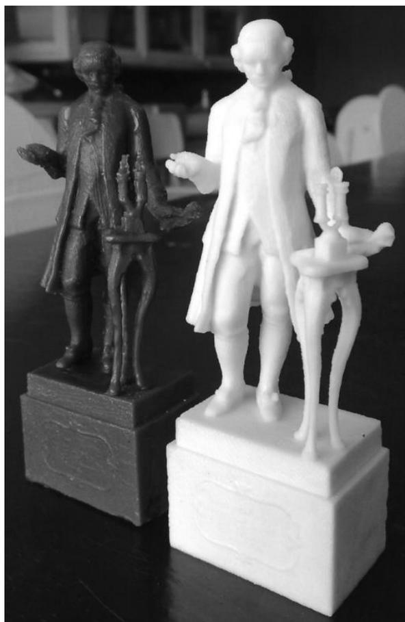
Рисунок 3 – Готовая восковая модель и модель-прототип
