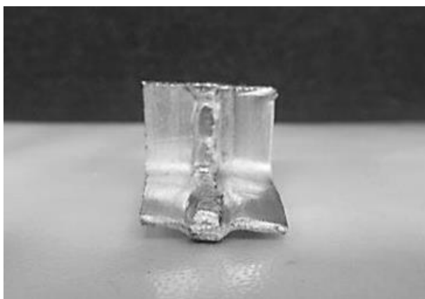
Рисунок 3 – Образец, сваренный РАД
