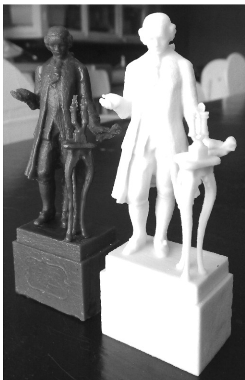
Рисунок 4 – Готовая восковая модель и модель-прототип
