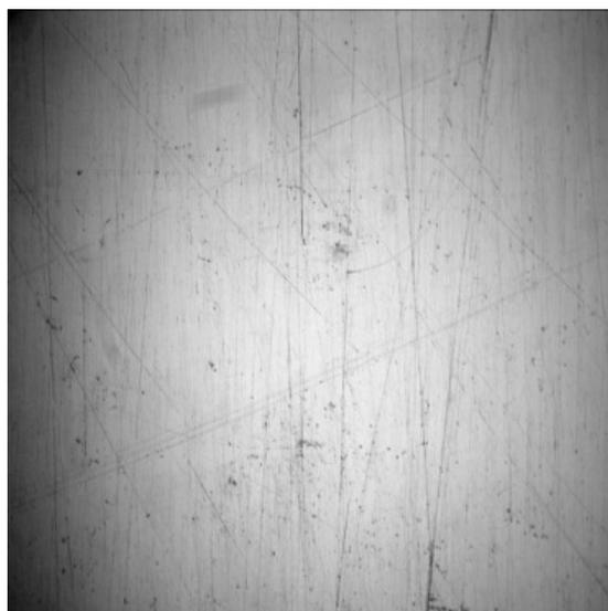
Рисунок 2 – Мелкие оксидные включения, глобулярные включения. x100
