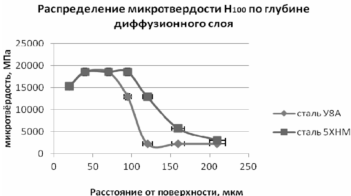
Рисунок 2 – Распределение микротвердости по глубине диффузионного слоя
