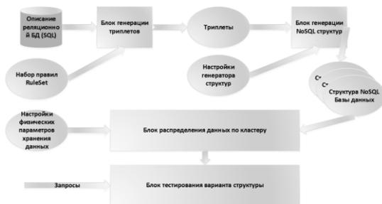
Рисунок 1 – Архитектура имитационной системы
