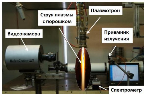
Рисунок 1 – Внешний вид экспериментальной установки
