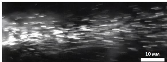
Рисунок 3 – Видеоизображение двухфазной плазменной струи с треками частиц  $ZrO_2$ .
