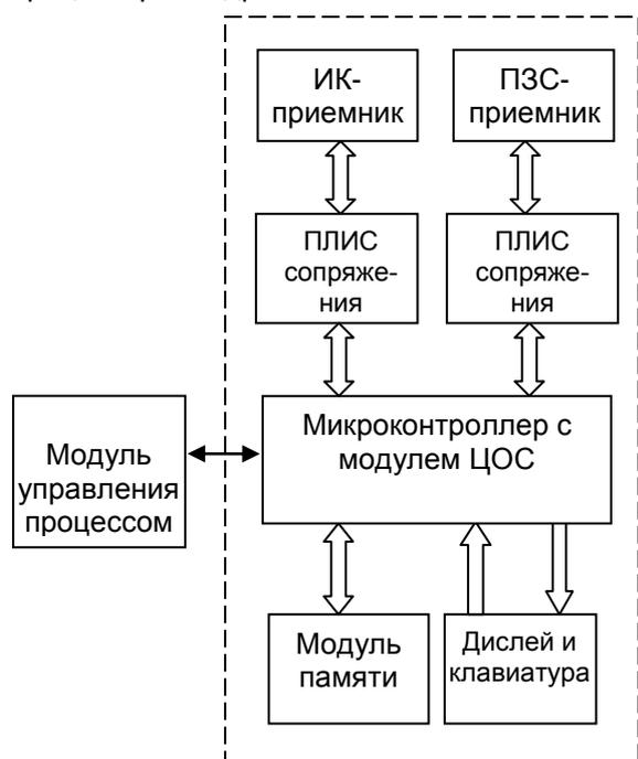
Рисунок 1 – Структурная схема интеллектуальной системы управления процессом СВС
