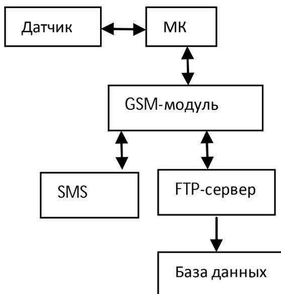
Рисунок 1 – Структурная схема ИИС для мониторинга температуры
