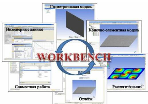
Рисунок 1 – Взаимодействие различных модулей в рамках платформы ANSYS Workbench
