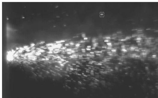
Рисунок 5 – Выделенный трек отдельной частицы в плазменном потоке (в прямоугольном окне в верхней части кадра)
