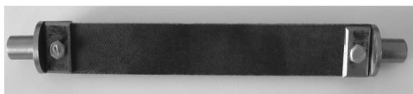
Рисунок 5 – Образец - пластина со сквозным дефектом из стеклопластика, защемленный в специальные захваты
