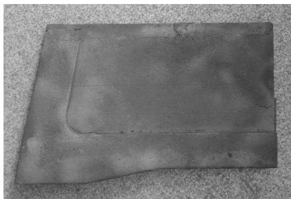
Рисунок 3 – Готовая отливка с упрочненной рабочей поверхностью
