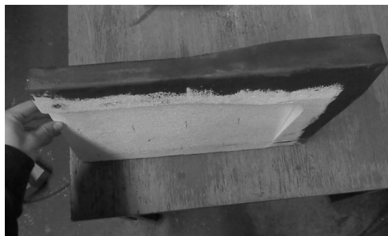
Рисунок 1 – Модель ножа с нанесенной на рабочую поверхность обмазкой
