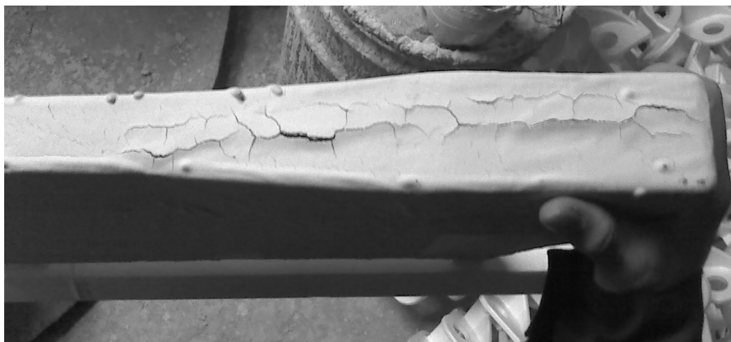
Рисунок 2 – Результат нарушение технологии сушки противопопригарного покрытия
