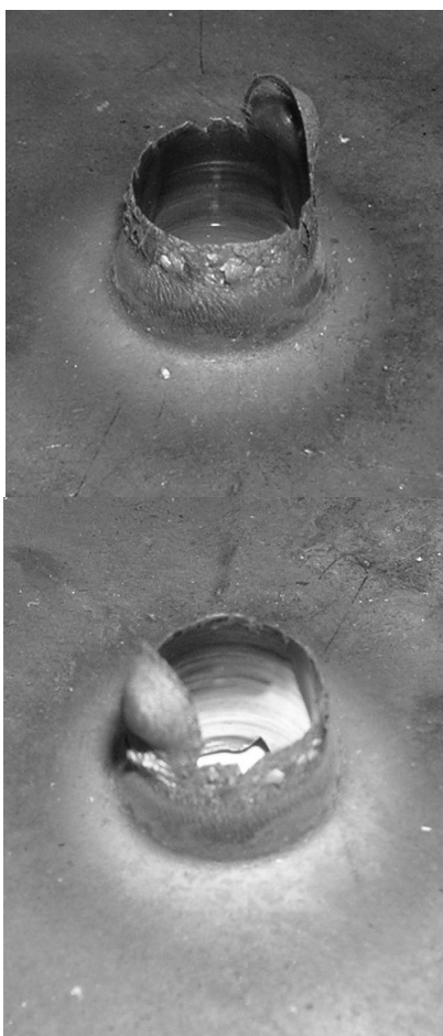
Рисунок 2 – Нижняя часть узла крепления. Подача 160 мм/мин.
