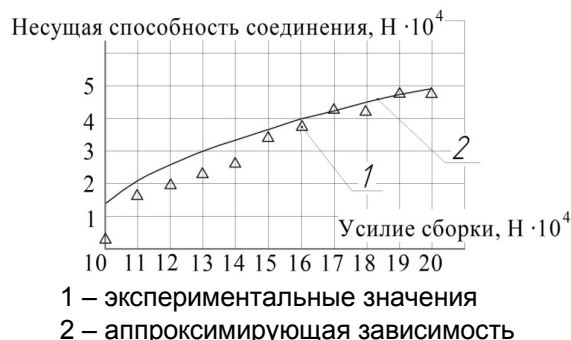
1 – экспериментальные значения 2 – аппроксимирующая зависимость Рисунок 4 – Зависимость несущей способности соединения от усилия сборки
