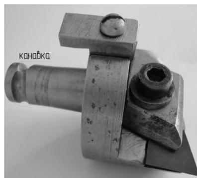
Рисунок 4 – Инструментальный модуль
