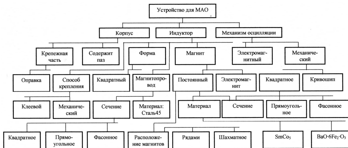
Рисунок 1 – Фрагмент И-ИЛИ графа устройств для магнитно-абразивной обработки
