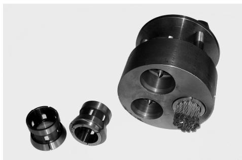
Рисунок 1 – Общий вид иглофрезы для снятия заусенцев
