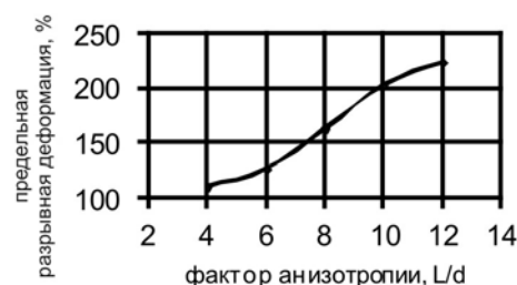
Рисунок 5 - Зависимость предельной разрывной деформации поливинилхлорида, наполненного волластонитом с 30 % содержанием с разным фактором анизотропии
