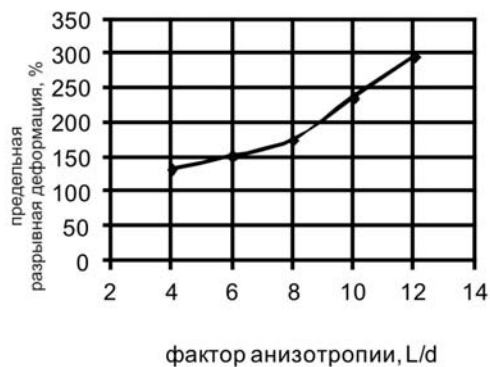
Рисунок 4 - Зависимость предельной разрывной деформации поливинилхлорида, наполненного волластонитом с 15 % содержанием с разным фактором анизотропии
