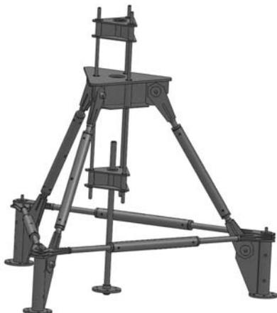
Рисунок 3 – Схема станда УУ-ВСК для испытаний выдергивающими нагрузками
