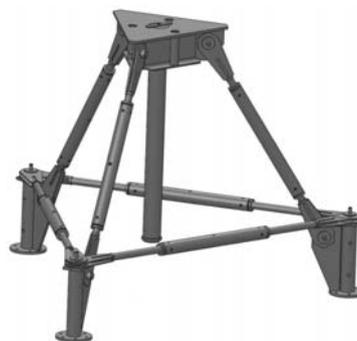
Рисунок 2 – Схема стенда УУ-ВСК для испытаний вдавливающими нагрузками
