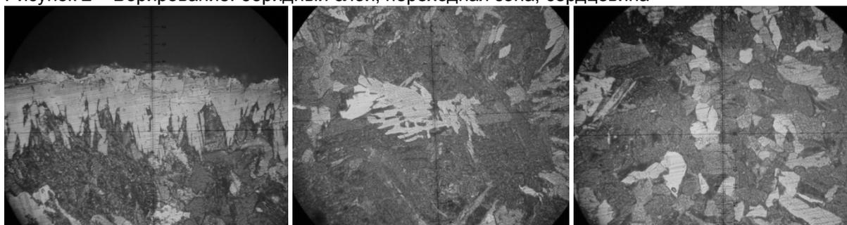
Рисунок 3 – Боротитанирование: боридный слой, переходная зона, сердцевина
