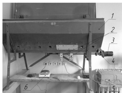
1 - бункер; 2 - высевальные аппараты; 3 - электродвигатель; 4 - муфта; 5 - блок управления; 6 – весы
